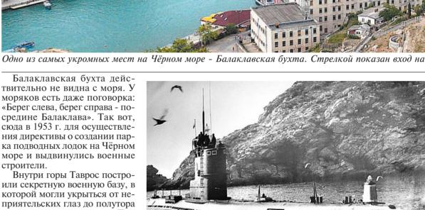
Дизель-электрическая подлодка проекта 613 в Балаклавской бухте. Оснащалась торпедами, включая торпеды с ядерными зарядами. Экипаж - 52 чел., 1960-е гг.
