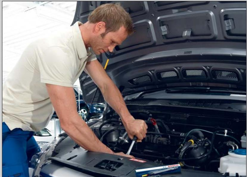
ления, выкрутить их бывает непросто. Поэтому эксперты рекомендуют по окончании холодного сезона выкрутить свечи накаливания и осмотреть их. Демонтаж следует осуществлять на предварительно прогретом двигателе, пользуясь динамометрическим ключом, чтобы не превысить допустимое усилие и не поломать свечу. Если свеча все же ломается в колодце, то двигатель запускать ни в коем случае нельзя. Следует снять головку блока цилиндров и удалить обломок.
