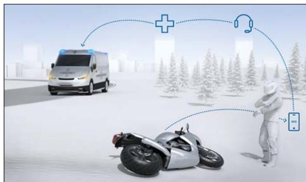
стационарно устанавливается в байк. Здесь Help Connect использует инерционный блок измерения, интегрированный в систему стабилизации мотоцикла.
