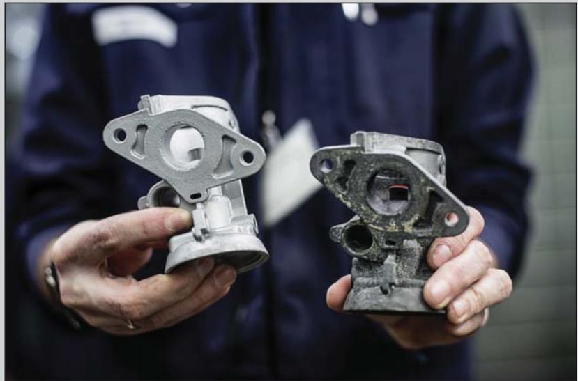
ходить стандартизацию по качеству ISO 9001:201. После разборки и чистки восстанавливаемых частей проводится их тщательный осмотр. Затем вместо изношенных компонентов устанавливаются новые. После сборки каждый продукт тщательно проверяется на современных испытательных стендах в соответствии со спецификациями оригинального оборудования. После этого производитель может гарантировать качество восстановленных запасных частей.
