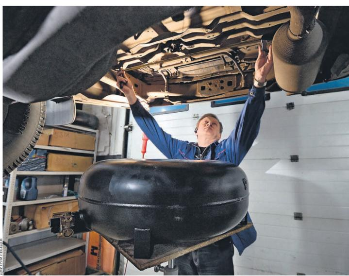
Самое популярное изменение конструкции машины — перевод двигателя на газовое оборудование
