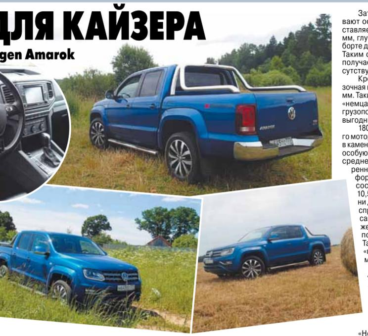
Зато размеры грузового отсека заслуживают особого внимания: полная ширина составляет нешуточные 1620 мм, длина — 1555 мм, глубина — 508 мм (при откинутом заднем борте длина кузова увеличивается до 2100 мм). Таким образом, вместительность «Амарока» получается больше, чем у конкурентов, присутствующих на нашем рынке.
