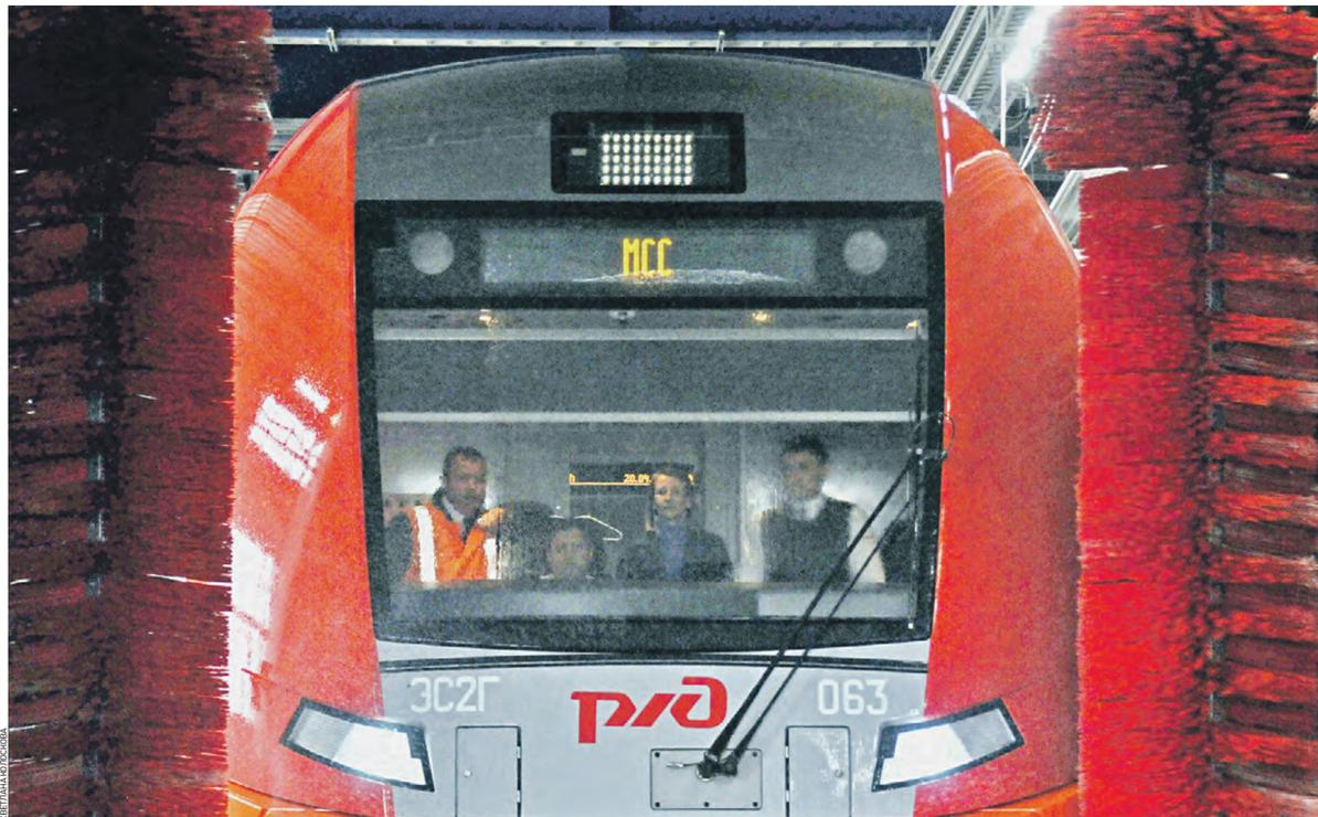
Вчера 12:38 Первый поезд «Ласточка» помыли в новом комплексе на станции «Андроновка». Подвижной состав обработали кислотным раствором, а после он прошел связью две большие щетки, которые натерли металлический корпус до блеска
