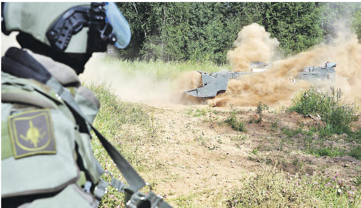
8 июля 2023 года. Военнослужащий 66-го учебного центра инженерных войск разминует местность с помощью робототехнического комплекса разминирования «Уран-6» в рамках подготовки к работе в зоне СВО
